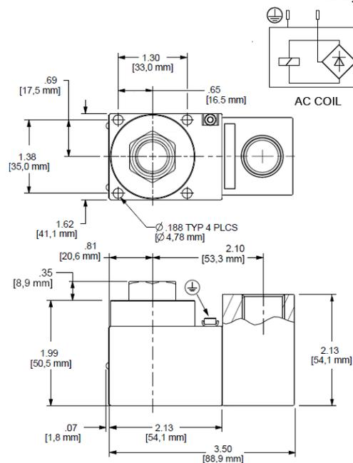
Die Spulen der 747-Serie für explosionsgefährdete Umgebungen sind kompatibel zu allen Schalt- und Proportionalventilen der Flex-Serie sowie allen Magnetventilen von SUN mit einem 16 mm Tubus. Alle Modelle sind nach ATEX, IECEx und NEC, CEC/CSA zertifiziert.
