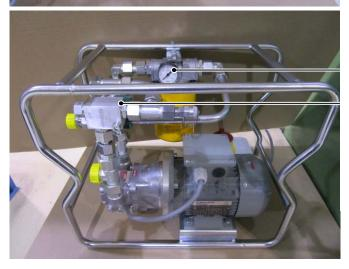
Manometer, Filterüberwachung Rückschlagventil, vorgespannt auf 5 bar
