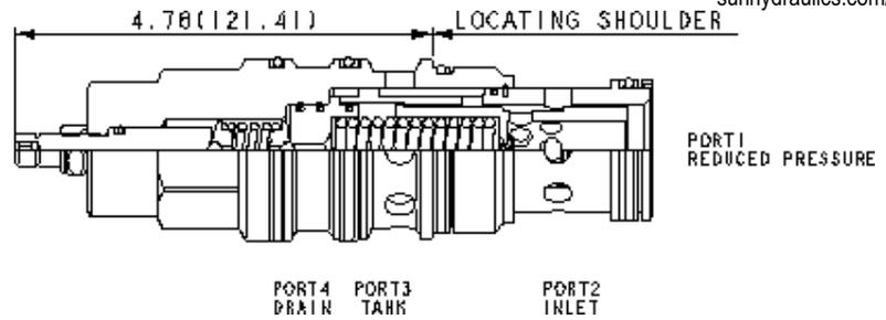
Dieses vorgesteuerte 3-Wege-Druckregelventil mit externer Entlastung reduziert einen hohen Primärdruck an Anschluss 2 auf einen niedrigeren, geregelten Druck an Anschluss 1. Bei Überdruck an Anschluss 1 fließt das Öl über Anschluss 3 zum Tank ab. Das Ventil wird nicht durch Staudruck an Anschluss 3 (Tank) beeinflusst, da die Vorsteuerung separat zu Anschluss 4 entlastet wird, der auch zur Fernsteuerung verwendet werden kann.
