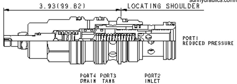
Entlastbare, vorgesteuerte 3-Wege-Druckregelventile reduzieren einen hohen Primärdruck an Anschluss 2 auf einen niedrigeren, geregelten Druck an Anschluss 1. Bei Überdruck an Anschluss 1 fließt Öl über Anschluss 3 zum Tank ab. Der Entlastungsanschluss 4 kann auch zur Fernsteuerung verwendet werden.
