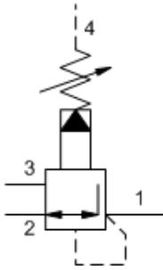
Dieses vorgesteuerte 3-Wege-Druckregelventil mit externer Entlastung reduziert einen hohen Primärdruck an Anschluss 2 auf einen niedrigeren, geregelten Druck an Anschluss 1. Bei Überdruck an Anschluss 1 fließt das Öl über Anschluss 3 zum Tank ab. Das Ventil wird nicht durch Staudruck an Anschluss 3 (Tank) beeinflusst, da die Vorsteuerung separat zu Anschluss 4 entlastet wird, der auch zur Fernsteuerung verwendet werden kann.
