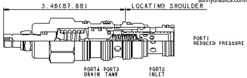
Dieses vorgesteuerte 3-Wege-Druckregelventil mit externer Entlastung reduziert einen hohen Primärdruck an Anschluss 2 auf einen niedrigeren, geregelten Druck an Anschluss 1. Bei Überdruck an Anschluss 1 fließt das Öl über Anschluss 3 zum Tank ab. Das Ventil wird nicht durch Staudruck an Anschluss 3 (Tank) beeinflusst, da die Vorsteuerung separat zu Anschluss 4 entlastet wird, der auch zur Fernsteuerung verwendet werden kann.
