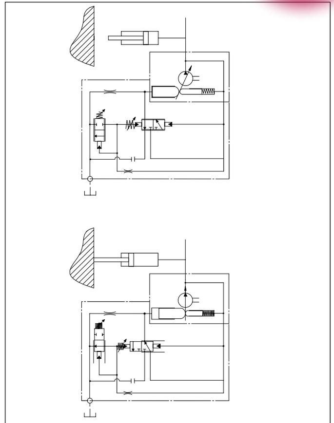
Nulleinstellung mit R1 Schraube (max. 400 bar)
