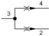
Stromteiler in Schieberkonstruktion teilen einen eingehenden Volumenstrom in einem fest vorgegebenen Teilungsverhältnis druckunabhängig in zwei Teilströme. Typische Anwendungsbeispiele: Steuerung von Hydraulikmotoren mit nur einer Drehrichtung, Zylindersteuerungen, bei denen die Stromteilung nur in einer Richtung erfolgen muss, Systeme mit nur einer Pumpe, aber zwei unabhängigen Teilströmen.
