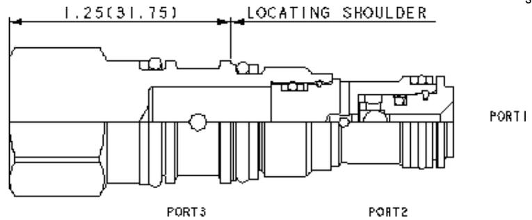
Das Wechselventil verbindet die Hochdruckseite zweier Zuläufe mit dem Signalabgriff. Der Signalabgriff ist an Anschluss 3.
