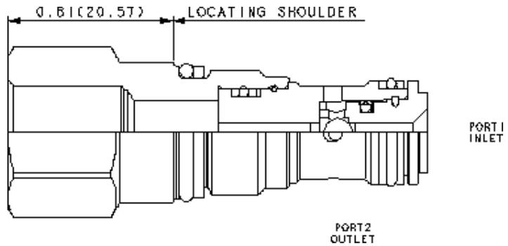
Das Wechselventil verbindet die Hochdruckseite zweier Zuläufe mit dem Signalabgriff. Ein Zulauf ist im Sechskant vom Ventilkopf und der Signalabgriff an Anschluss 2.
