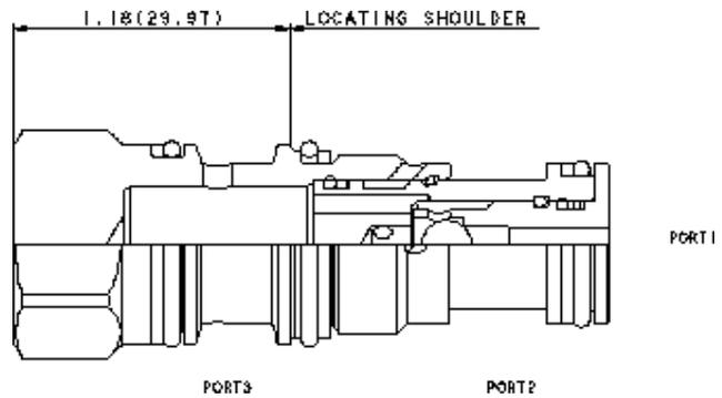
Das Wechselventil verbindet die Hochdruckseite zweier Zuläufe mit dem Signalabgriff. Der Signalabgriff ist an Anschluss 3.
