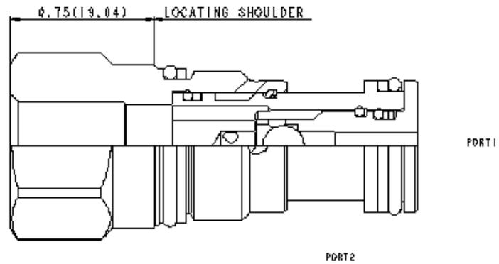
Das Wechselventil verbindet die Hochdruckseite zweier Zuläufe mit dem Signalabgriff. Der Anschluss für den externen Signalabgriff ist im Sechskant vom Ventilkopf.
