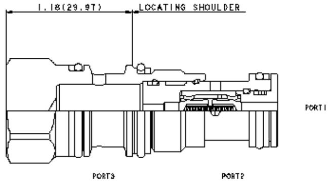
Das Wechsel-Rückschlagventil beinhaltet zwei einfache Rückschlagventile in einem Ventil. Es verbindet den Zulauf mit dem höheren Druck zum Signalabgriff. Der Signalabgriff ist an Anschluss 2.
