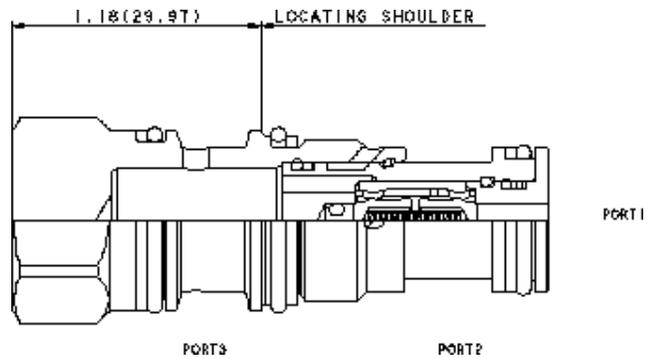
Das Wechsel-Rückschlagventil beinhaltet zwei einfache Rückschlagventile in einem Ventil. Es verbindet den Zulauf mit dem höheren Druck zum Signalabgriff. Der Signalabgriff ist an Anschluss 3.
