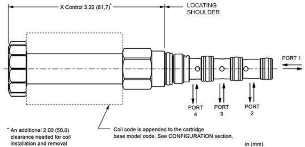
Das 4/2-Wege Magnetventil der FLeX-Serie ist ein direktgesteuertes Ventil in druckausgeglichener Schieberbauweise.
