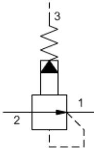
Vorgesteuerte 2-Wege-Druckregler reduzieren einen hohen Primärdruck an Anschluss 2 auf einen niedrigeren, geregelten Druck an Anschluss 1. Dadurch können Schaltungen mit unterschiedlichen Drücken von einer Pumpe versorgt werden.
