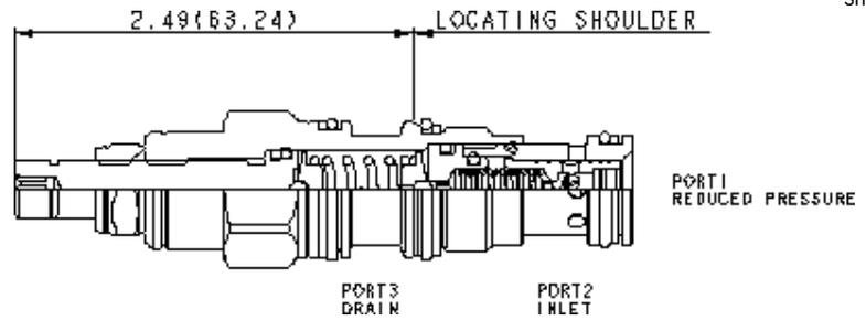
Vorgesteuerte 2-Wege-Druckregler reduzieren einen hohen Primärdruck an Anschluss 2 auf einen niedrigeren, geregelten Druck an Anschluss 1. Dadurch können Schaltungen mit unterschiedlichen Drücken von einer Pumpe versorgt werden.
