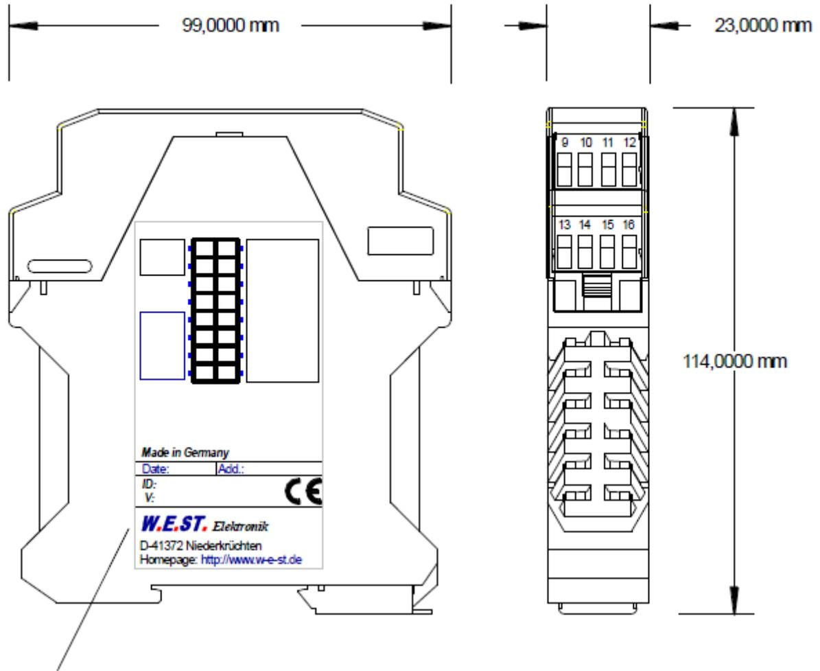
Typenschild und Anschlussbelegung
