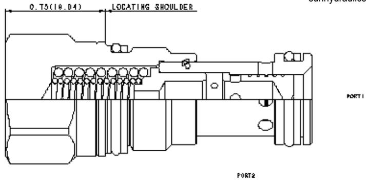
Dieses Ventil wurde als Spülventil konzipiert, bei dem die Funktionsteile direkt in ein Gehäuse eingebaut sind. Zwei stirnseitig positionierte Ventile mit einem Stößel dazwischen bilden ein Spülventil.
