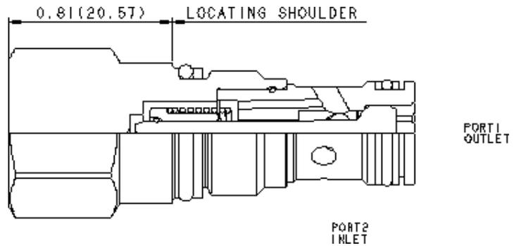
Rückschlagventile von SUN sind schaltende Ventile. Diese Version gibt den Volumenstrom von Anschluss 2 nach 1 frei und sperrt in umgekehrter Richtung.
