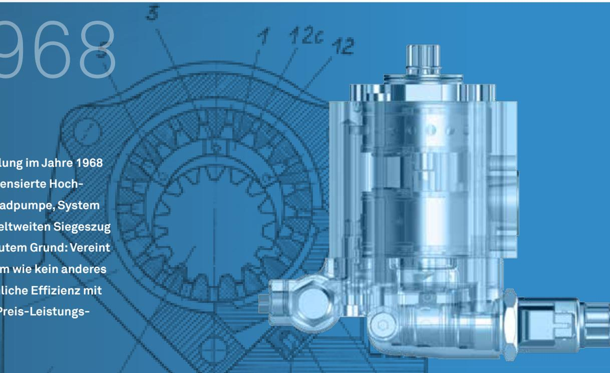
Die Grundlage für diese Bestwerte ist die innovative Konstruktion, bei der das treibende Zahnrad exzentrisch in der Innenverzahnung läuft. Das Medium, zum Beispiel Hydrauliköl, wird in den Räumen zwischen den Zahnücken der beiden Zahnräder gefördert, wobei die Zähne durch das geteilte Füllstück abgedichtet werden.
