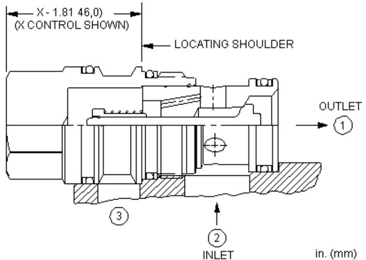
Dieses Rückschlagventil entspricht einem Standard Rückschlagventil mit zwei Anschlüssen in einer Einschraubbohrung mit drei Anschlüssen, wobei der Anschluss 3 des Einschraubventils verschlossen ist. Dieses Ventil ist einzusetzen in Schaltungen, in denen ein Rückschlagventil in einer vorhandene Einschraubbohrung mit drei Anschlüssen benötigt wird.
