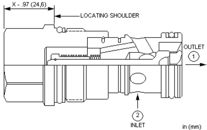
Rückschlagventile von SUN sind schaltende Ventile. Diese Version gibt den Volumenstrom von Anschluss 2 nach 1 frei und sperrt in umgekehrter Richtung.
