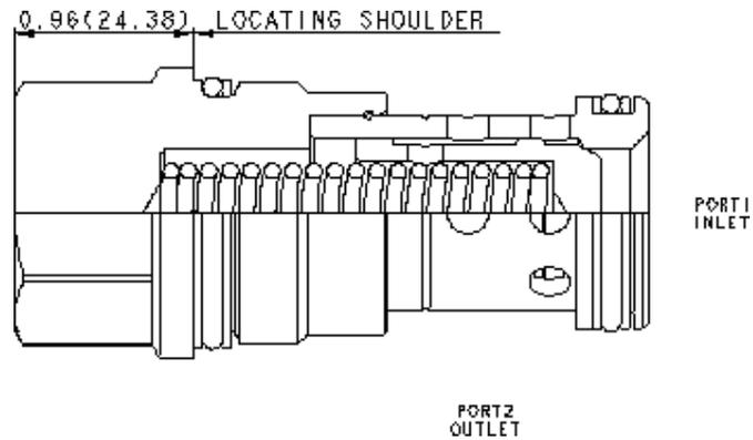
Rückschlagventile von SUN sind schaltende Ventile. Diese Version gibt den Volumenstrom von Anschluss 1 nach 2 frei und sperrt in umgekehrter Richtung.
