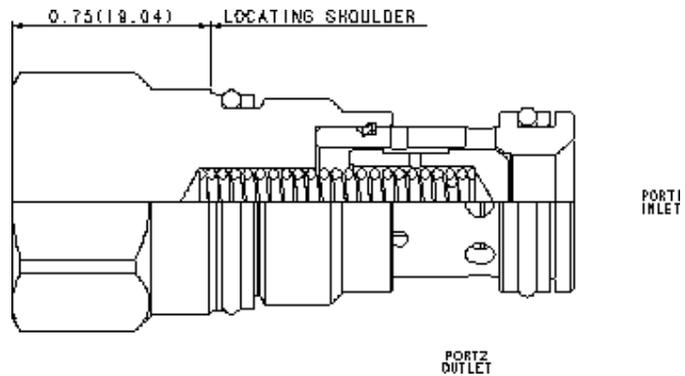
Rückschlagventile von SUN sind schaltende Ventile. Diese Version gibt den Volumenstrom von Anschluss 1 nach 2 frei und sperrt in umgekehrter Richtung.
