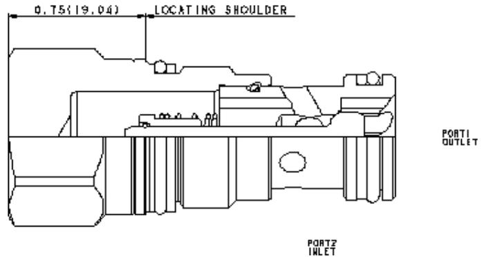
Rückschlagventile von SUN sind schaltende Ventile. Diese Version gibt den Volumenstrom von Anschluss 2 nach 1 frei und sperrt in umgekehrter Richtung.
