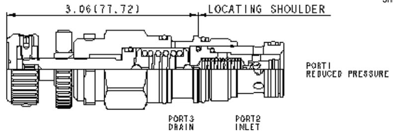
Vorgesteuerte 2-Wege-Druckregler reduzieren einen hohen Primärdruck an Anschluss 2 auf einen niedrigeren, geregelten Druck an Anschluss 1. Dadurch können Schaltungen mit unterschiedlichen Drücken von einer Pumpe versorgt werden.
