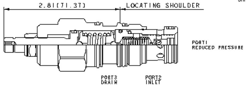
Vorgesteuerte 2-Wege-Druckregler reduzieren einen hohen Primärdruck an Anschluss 2 auf einen niedrigeren, geregelten Druck an Anschluss 1. Dadurch können Schaltungen mit unterschiedlichen Drücken von einer Pumpe versorgt werden.
