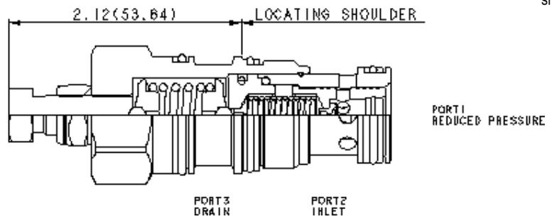
Vorgesteuerte 2-Wege-Druckregler reduzieren einen hohen Primärdruck an Anschluss 2 auf einen niedrigeren, geregelten Druck an Anschluss 1. Dadurch können Schaltungen mit unterschiedlichen Drücken von einer Pumpe versorgt werden.
