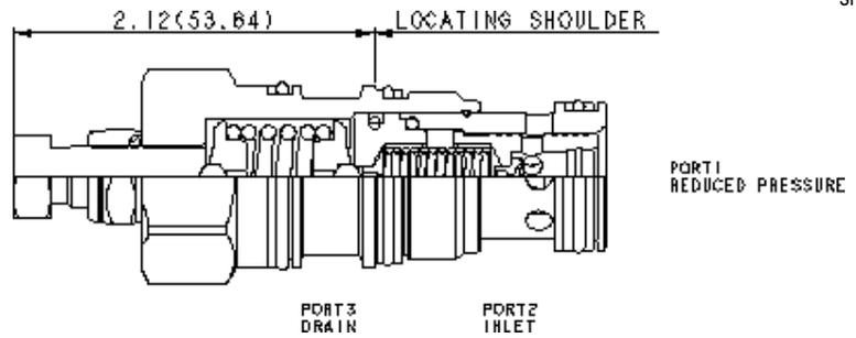
Vorgesteuerte 2-Wege-Druckregler reduzieren einen hohen Primärdruck an Anschluss 2 auf einen niedrigeren, geregelten Druck an Anschluss 1. Dadurch können Schaltungen mit unterschiedlichen Drücken von einer Pumpe versorgt werden.
