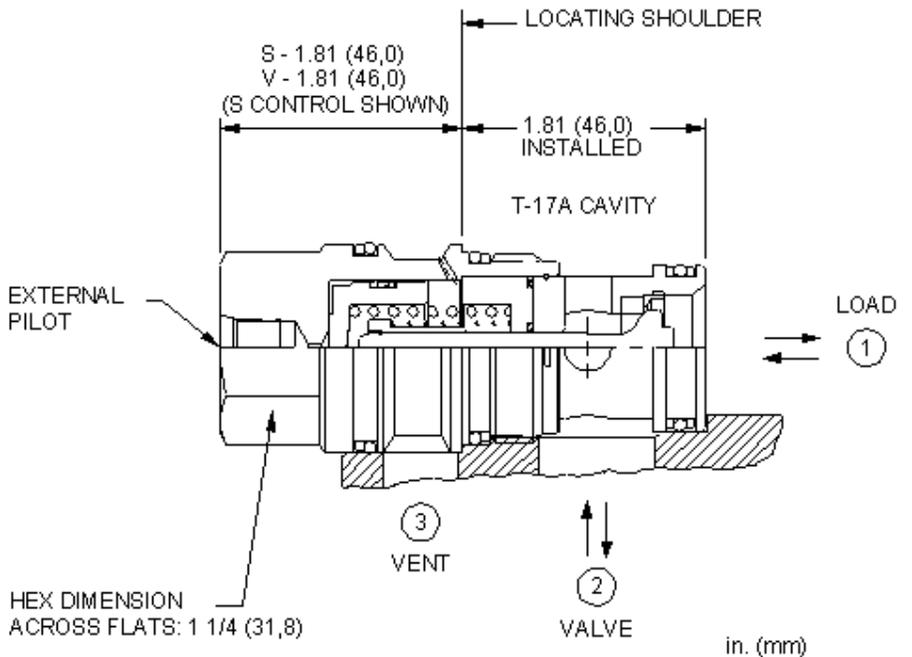
Dieses Ventil ist ein entsperrbares Rückschlagventil. Es hat einen abgedichteten Steuerkolben, einen Delrinsitz und ist entlastet. Es hat freien Durchfluss zur Last (Anschluss 2 nach 1) und sperrt in Gegenrichtung. Druck am externen Anschluss öffnet das Ventil von Anschluss 1 nach 2. Der benötigte Steuerdruck ist direkt proportional zum Lastdruck an Anschluss 1. Das Ventil ist unabhängig von Druck an Anschluss 2, da der Federraum zum Anschluss 3 entlastet ist.
