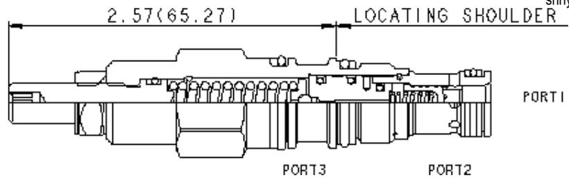
Diese 3-Wege-Druckwaage ist ein in der Ruhestellung geschlossenes Regelement mit Druckbegrenzungsfunktion, das zusammen mit einer externen Blende zwei Funktionen erfüllt: Der Hauptkolben der 3-Wege-Druckwaage hält die Druckdifferenz über die externe Blende konstant. Überschüssiger Volumenstrom wird zum Tank (Anschluss 2) abgeführt. Bei Erreichen des Druckeinstellwerts verhält sich das Ventil wie ein Druckbegrenzungsventil.
