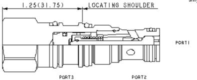
Dieses Ventil ist ein entsperrbares Rückschlagventil. Es hat einen abgedichteten Steuerkolben, einen Stahlsitz und ist ohne Entlastung. Es hat freien Durchfluss zur Last (Anschluss 2 nach 1) und sperrt in Gegenrichtung. Druck an Anschluss 3 öffnet das Ventil von Anschluss 1 nach 2. Der benötigte Steuerdruck an Anschluss 3 ist direkt proportional zum Lastdruck an Anschluss 1. Druck an Anschluss 2 wirkt gegen den Steuerdruck.
