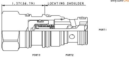
Dieses Ventil ist ein entsperrbares Rückschlagventil. Es hat einen abgedichteten Steuerkolben, einen Stahlsitz und ist ohne Entlastung. Es hat freien Durchfluss zur Last (Anschluss 2 nach 1) und sperrt in Gegenrichtung. Druck an Anschluss 3 öffnet das Ventil von Anschluss 1 nach 2. Der benötigte Steuerdruck an Anschluss 3 ist direkt proportional zum Lastdruck an Anschluss 1. Druck an Anschluss 2 wirkt gegen den Steuerdruck.
