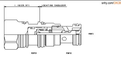
Dieses Ventil ist ein entsperrbares Rückschlagventil. Es hat einen nicht abgedichteten Steuerkolben, einen Stahlsitz und ist ohne Entlastung. Es hat freien Durchfluss zur Last (Anschluss 2 nach 1) und sperrt in Gegenrichtung. Druck an Anschluss 3 öffnet das Ventil von Anschluss 1 nach 2. Der benötigte Steuerdruck an Anschluss 3 ist direkt proportional zum Lastdruck an Anschluss 1. Druck an Anschluss 2 wirkt gegen den Steuerdruck.
