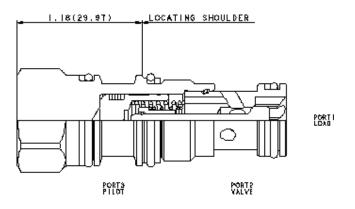
Dieses Ventil ist ein entsperrbares Rückschlagventil. Es hat einen nicht abgedichteten Steuerkolben, einen Stahlsitz und ist ohne Entlastung. Es hat freien Durchfluss zur Last (Anschluss 2 nach 1) und sperrt in Gegenrichtung. Druck an Anschluss 3 öffnet das Ventil von Anschluss 1 nach 2. Der benötigte Steuerdruck an Anschluss 3 ist direkt proportional zum Lastdruck an Anschluss 1. Druck an Anschluss 2 wirkt gegen den Steuerdruck.
