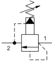
Vorgesteuerte, reaktionsschnelle Druckbegrenzungsventile mit druckausgeglichenem Kolben sind in der Ruhestellung geschlossen und schützen hydraulische Bauteile vor Druckstößen. Schnelles Öffnen und Schließen wurde auf Kosten der Stabilität erreicht. Wenn der Druck (Anschluss 1) den Einstellwert des Ventils überschreitet, wird der überschüssige Druck zum Tank (Anschluss 2) entlastet. Diese Ventile haben einen geringen Druckanstieg über dem Volumenstrom und sind sehr reaktionsschnell.
