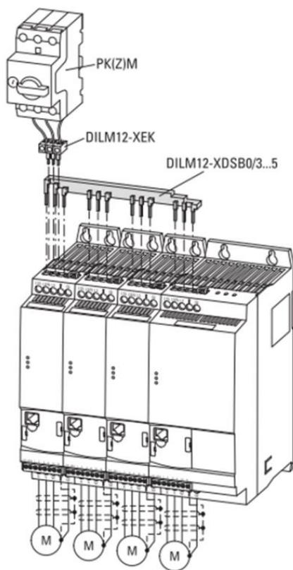
In allen oben beschriebenen Situationen ist eine direkte Montage der Drehzahlstarter aneinander zulässig. Dies ermöglicht die Verwendung von Drehstromschienenblöcken DILM12-XDSB0/3...5 zur parallelen Einspeisung und die Verwendung von einem gemeinsamen Schutzorgan auf der Netzseite bis zu einem Gesamtstrom von 30 A.
