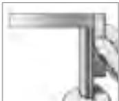
2. Rohr rechtwinklig abtrennen (keinen Rohrabschneider verwenden). Rohrenden innen und außen leicht entgraten. Nicht anfasen! Reinigen.
