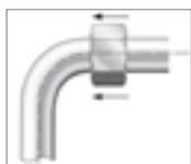
4. Überwurfmutter auf das Rohr schieben.
