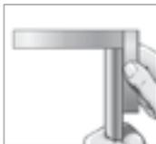
Vom Trennschnitt durch den Rohrhersteller min. 10 mm absägen (lieferbedingte Fehlerquelle). Rohr rechtwinklig absägen, 1/2° Winkelabweichung zur Rohrachse ist zulässig. Keine Rohrabschneider oder Trennscheiben verwenden, sie ergeben eine starke Gratbildung und Schrägschnitt. Sägemaschine oder Vorrichtung benutzen.
