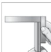
Vom Trennschnitt durch den Rohrhersteller min. 10 mm absägen (lieferbedingte Fehlerquelle). Rohr rechtwinklig absägen,  $\frac{1}{2}^\circ$  Winkelabweichung zur Rohrachse ist zulässig. Keine Rohrabschneider oder Trennscheiben verwenden, sie ergeben eine starke Gratbildung und Schrägschnitt. Sägemaschine oder Vorrichtung benutzen.
