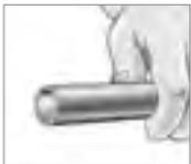
5. Hülse muß mit Rohrende bündig abschließen.
