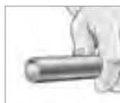
5. Hülse muß mit Rohrende bündig abschließen.
